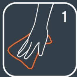
1 La superficie debe quedar libre de suciedad y grasa, se recomienda barrer y luego limpiar con alcohol o acetona ya que el colocar la cinta sobre una superficie sucia, puede producir su desprendimiento.
