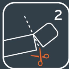
2 Corte la cinta antiderrapante al tamaño deseado redondeando los bordes, no aplique sobre fisuras o uniones de pisos.
